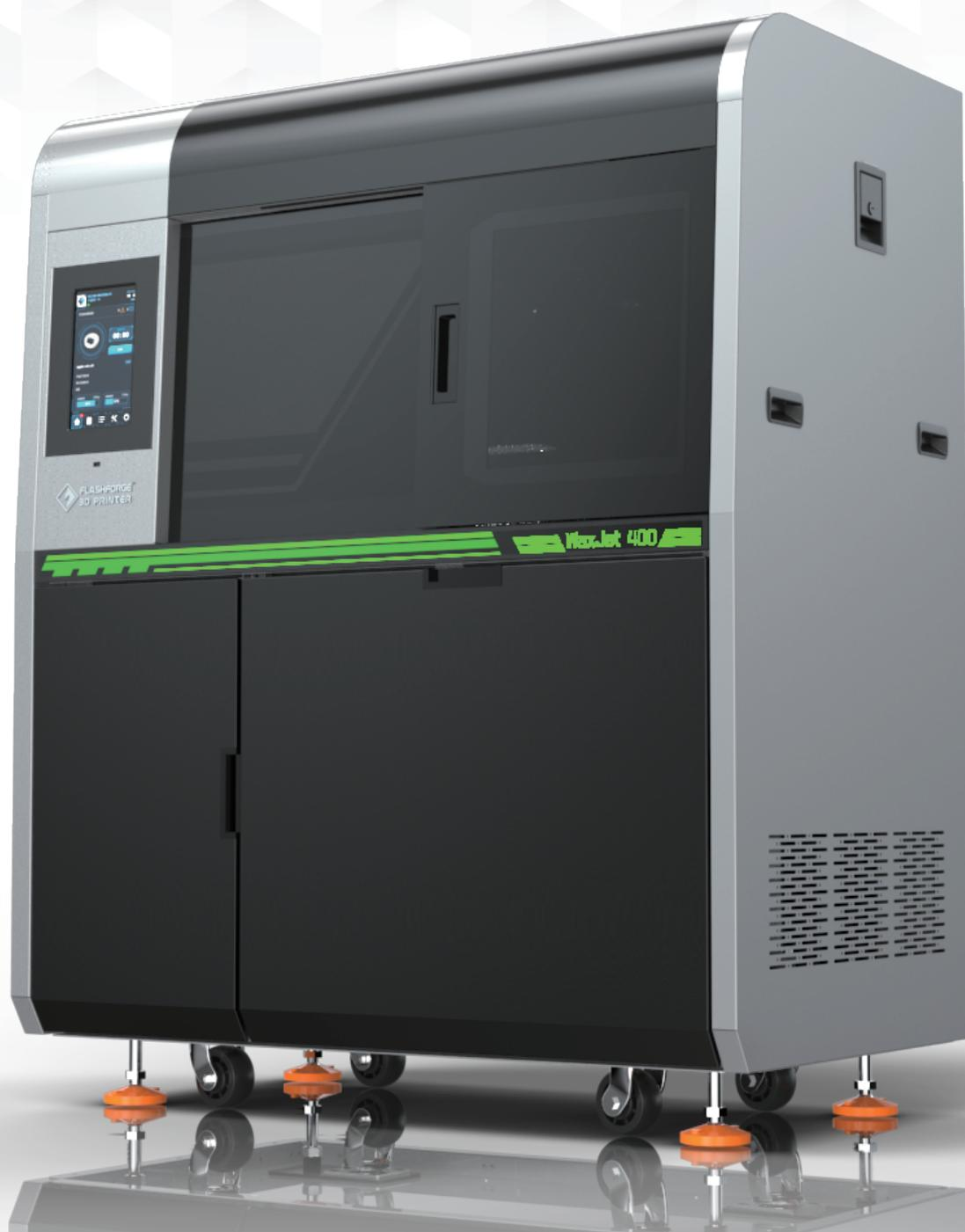
Линейка принтеров включает в себя модели WaxJet 400 и 410, которые используют технологию многоструйной печати для создания высокоточных восковых форм. Благодаря большому размеру принтеров модели могут быть размещены в несколько рядов как горизонтально, так и вертикально; толщина каждого слоя – 0,016 мм. Оборудование отлично подходит для создания ювелирных изделий, часов, инструментов и сувениров, а также для литья по выплавляемым моделям в аэрокосмической промышленности.
